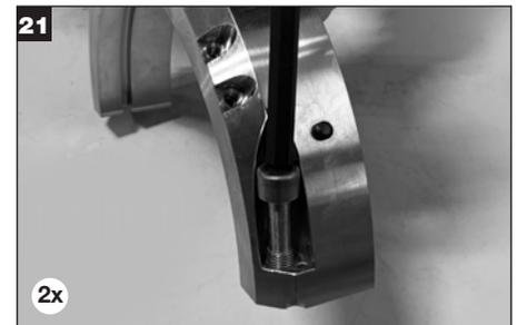
Lubrifique as roscas com um composto antiaderente recomendado e instale os parafusos Allen na metade do suporte rotativo.
