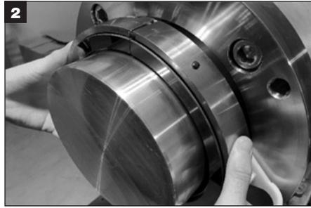
Use os pinos para juntar as metades do conjunto do suporte rotativo sobre o eixo. **Cuidado: NÃO** use os espaçadores de instalação do suporte como manipuladores. **Nota:** se não for possível girar o eixo manualmente, a linha das fendas do suporte **não deve** ficar alinhada com a linha das fendas da sobreposta (consulte as etapas 11 e 16).
