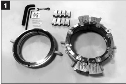
Remova o selo da embalagem e coloque sobre uma superfície de trabalho limpa. Certifique-se de que os espaçadores de instalação estão assentados no diâmetro externo das metades do suporte rotativo.
