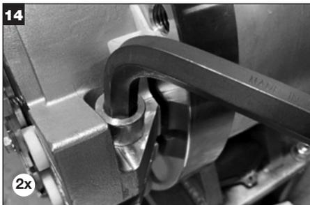
Aperte os parafusos Allen da sobreposta alternadamente de acordo com o torque especificado (consulte a Tabela 4 – Valores de torque para os parafusos da sobreposta).
