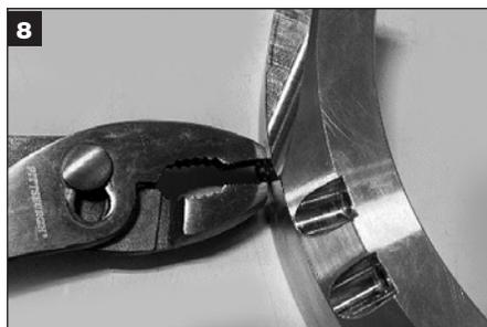
8 Remova os botões centralizadores (6x) do diâmetro externo do suporte rotativo.
