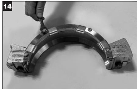
Remova os parafusos sextavados (8x) que conectam a placa de molas à sobreposta. Remova as metades de placa de molas das metades da sobreposta.
