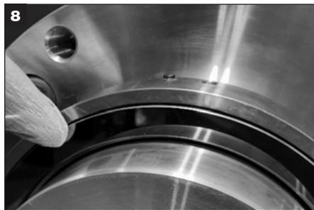
Limpe a face rotativa com o pano para limpeza fornecido, certificando-se de não há detritos nas fendas. **Cuidado:** não empurre a face do selo, pois ela poderá ficar desalinhada.
